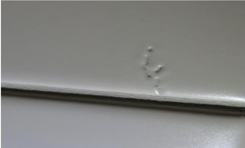
Kuva 15 Laatan pinnassa valmistuksessa syntynyt virhe
